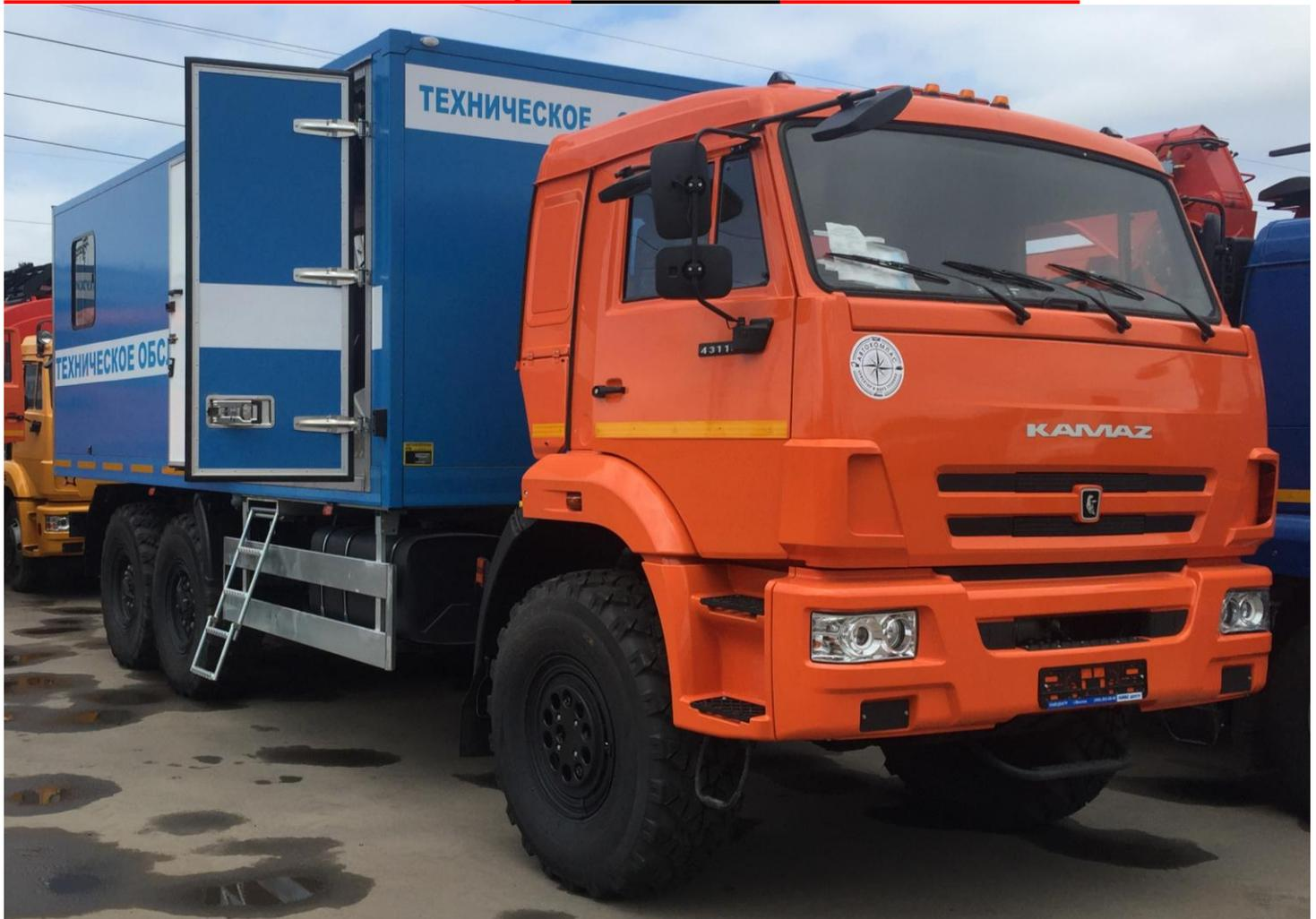
Базовое шасси КАМАЗ-43118-50 (6x6, ДВС КАМАЗ 740.705-300 (Е-5), КПП ZF9, топливные баки 350 + 210 л., спальное место, МКБ, МОБ, ТНВД BOSCH, система нейтрализ. ОГ(AdBlue), Common Rail, ДЗК, УВЭОС, новое 2019 г.в.)
